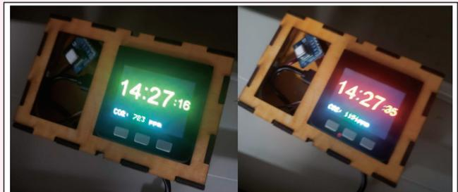
デバイス構築の事例：CO<sub>2</sub>の濃度によって色が変わる時計
