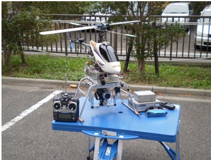
市販の模型ヘリコプタをベースとした実験機 操縦支援装置により、誰でも簡単に操縦できる！
