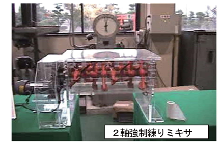
写真-2 可視化実験手法を用いた高性能な施工機械の開発例
