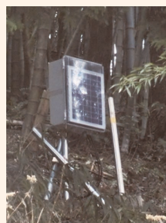
図1 静電容量型水分計による斜面の水分・水位モニタリング (金沢大との共同研究)
