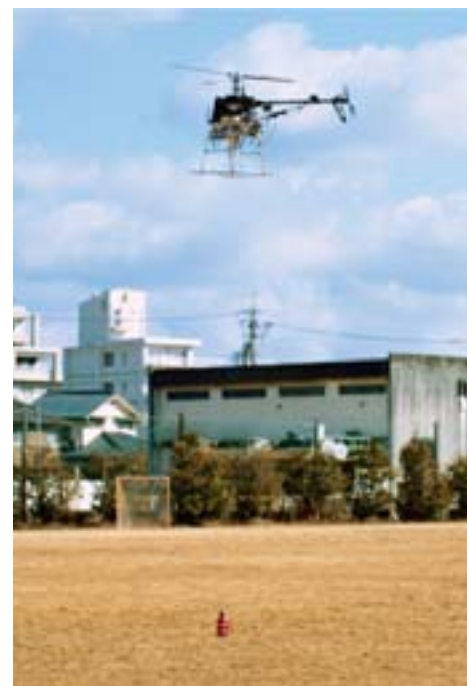
図1 物体を吊り上げた飛行実験の様子
