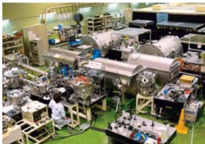
図：軟X線イメージング光学系の全景。軟X線は大気中を透過出来ないため、全て真空内に光学系を構築している。
