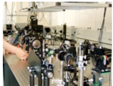
フェムト秒パルスを用いた非線形光学応答の測定系
