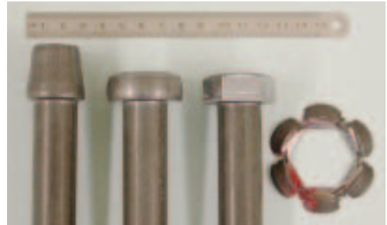
図1 六角ボルトの成型工程例
