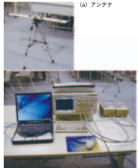
(a) アンテナ (b) 受信・解析システム 図 1 電磁波センシングシステム
