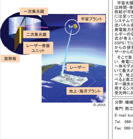
宇宙太陽光発電システム(SSPS: Space Solar Power System) は時間・季節や天候に左右されず,より多くの安定的な電力 供給が可能な概念であり、技術的な課題のため未だ実用化 には至っていないが、今後の実用化が期待されている。この システムでは、例えば静止軌道上に2.5km×2.5kmの太陽電 池パネルを展開することで、およそ原発1基分(100万MW)の 発電能力を有する。SSPSでは宇宙空間から地上までのエネ ルギーの伝送方式としてレーザー方式とマイクロ波による方 式が考えられているが、このうちレーザー方式SSPS(L-SSPS)では宇宙における発電・発振部の半導体レーザー部 からの排熱の問題と、地上部における高密度な受光レー ザーからのエネルギー変換が問題になる。
